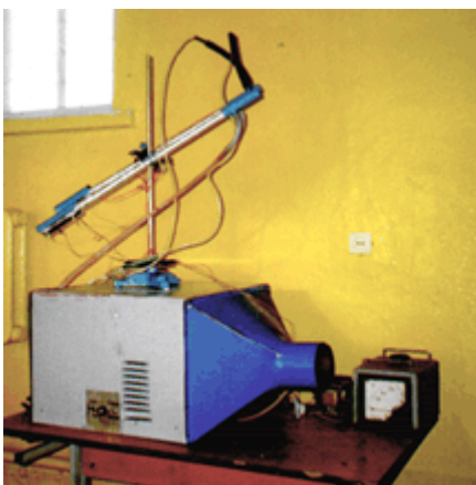
Фото теплового насоса воздух-вода, теплопроизводительностью нагрева воды 3 кВт:
